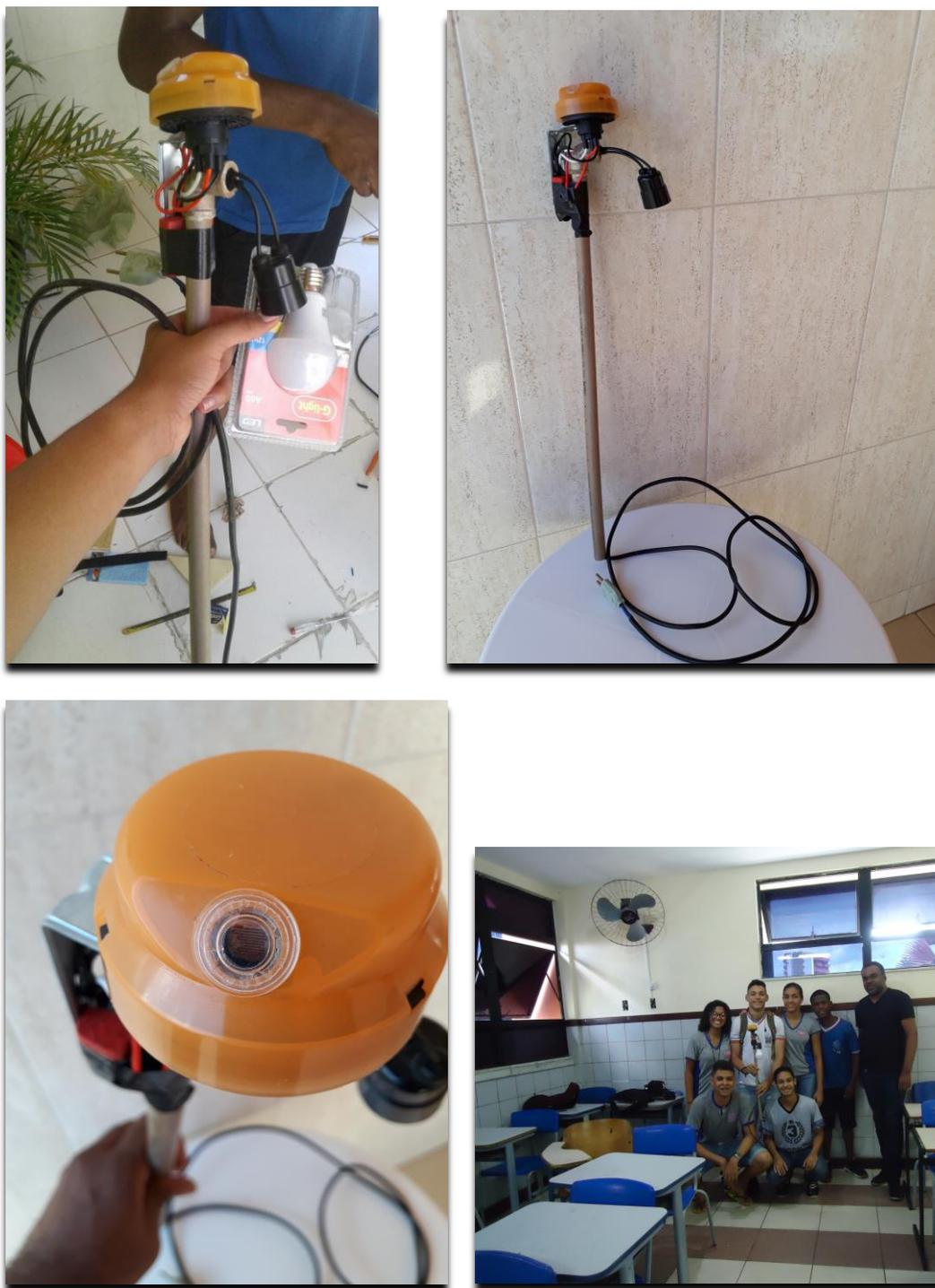
As imagens acima mostram que a equipe usou um relé de poste de iluminação para simular justamente o que o mesmo faz: quando não há incidência de luz, o fotorresistor não bloqueia a passagem de corrente e uma lâmpada acoplada em um
